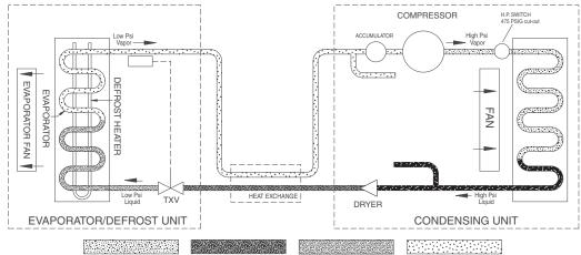
HIGH PRESSURE VAPOR HIGH PRESSURE LIQUID LOW PRESSURE LIQUID LOW PRESSURE VAPOR
