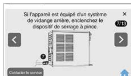
10. Unités avec Réservoir d'eau chaude : Repérez le dispositif de serrage à pince et enclenchez-le (position fermée) (**Fig. 26**).
